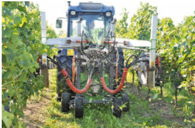
Fig. 13 - Sfogliatura eseguita alla fioritura con macchina pneumatica e, a destra, all'invasiatura con macchina ad aspirazione
