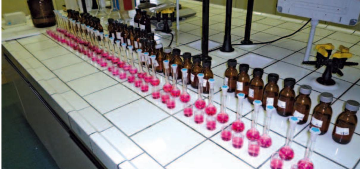
Particolare del momento di quantificazione degli antociani presenti nei campioni d'uva. Batteria di provette pronta per la lettura allo spettrofotometro
