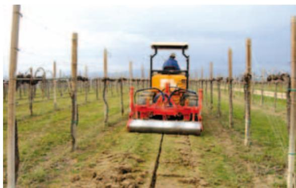
Fig. 5 - Lavorazione dell'interfilare con attrezzo combinato per il taglio centrale profondo (funzione drenante) e due laterali (azione di arieggiamento).
