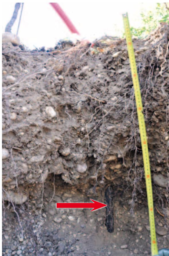
*Fig. 1 - Particolare del pozzetto di misura attraverso il quale veniva determinata l'umidità del suolo. A sinistra tubo in plastica rosso per evidenziare la presenza del pozzetto ed evitare l'accidentale urto con le macchine operatrici in vigneto, a destra particolare del pozzetto intorno ai 60 cm di profondità.*
