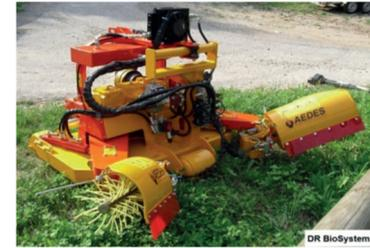
**Minicingolato con trincia laterale rientrante, trincia doppio rientrante e trincia centrale con flagelli laterali rientranti.**
