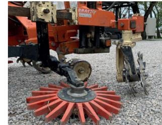
**Alternative già presenti nei comprensori viticoli: disco motrice, la lama ed il vomere tutti doppi e dotati di tastatori per il rientro automatico e ancora il Rollhacke e il Fingerhacke sempre per la lavorazione meccanica sottochioma.**
